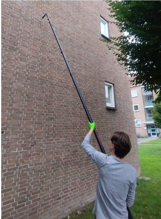
Figuur 3. eDNA monstername met behulp van een spons. Hierbij wordt de spons gemonteerd op een telescoopstok.
