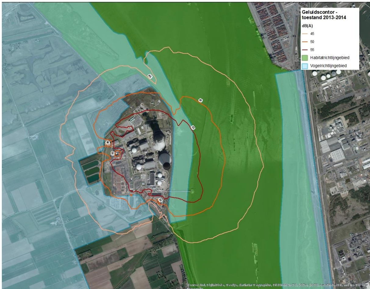
Figuur 45: Geluidscontouren van de continu werkende bronnen tijdens de dag-, avond, en nachtperiode (Bron: MER Arcadis/NRG, 2021).
