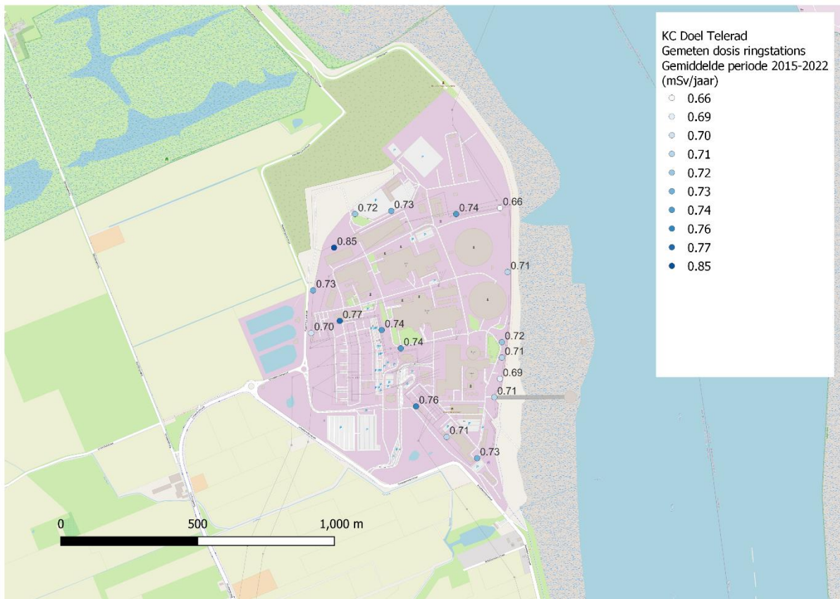
Figuur 65: Jaarlijkse dosis in mSv (gemiddelde over periode 2015 tot en met 2022) zoals gemeten door de TELERAD stations uitgebaat door het FANC-AFCN rondom de site van KC Doel (Figuur gemaakt op basis van 10-minuten data bekomen van het FANC-AFCN).
