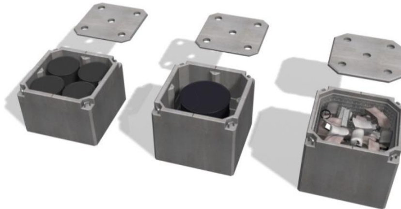
Figuur 27: Illustraties van de drie types caissons lvi met afval: type I (links), type II (midden) en type III (rechts). Na plaatsing van het deksel en opvulling van de ruimte tussen afval en caisson met vulmortel worden deze bergingscolli "monolieten" genoemd.
