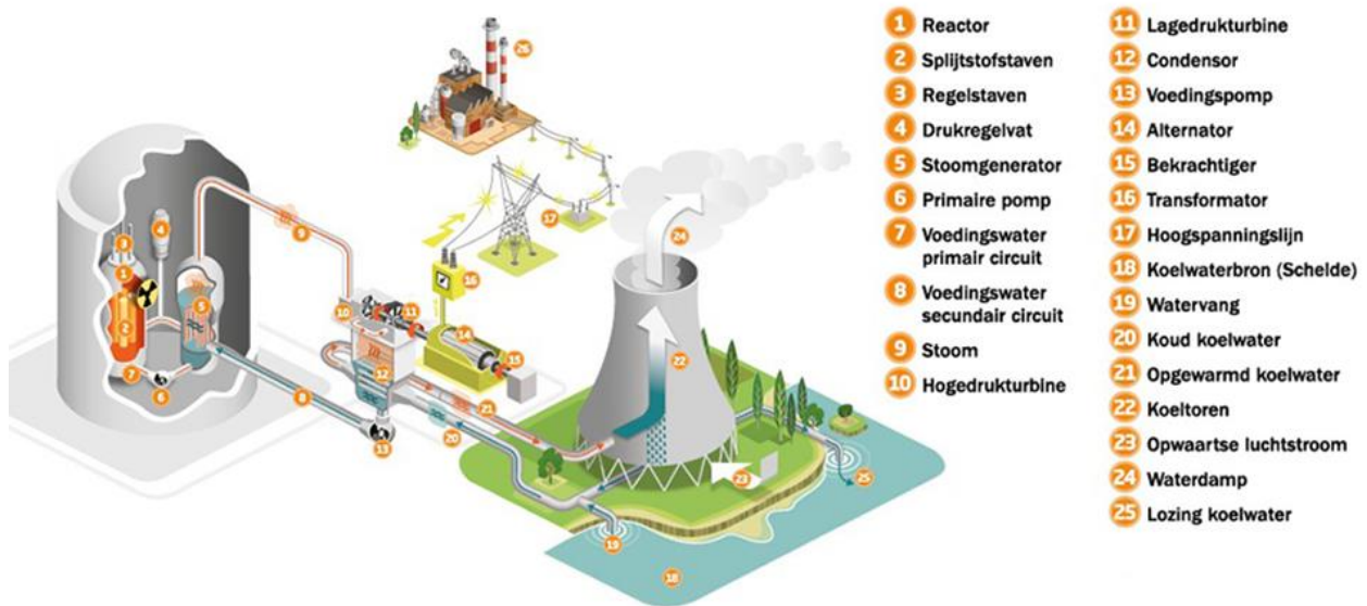
Figuur 3: Werking kerncentrale met van links naar rechts reactorgebouw, machinezaal en koelcircuit (Bron: Electrabel nv).
