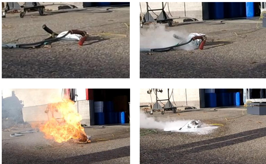
Figuur 2. Linksonder: Handmatige ontvlaming van cel. Rechtsboven: Geblust met Berki Cold
