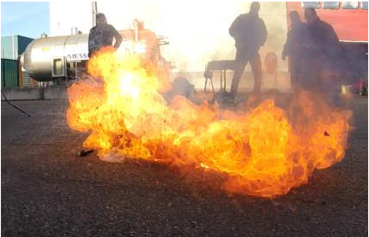
Figuur 11. Cel 1 vat vlam na opnieuw aansluiten van voeding
