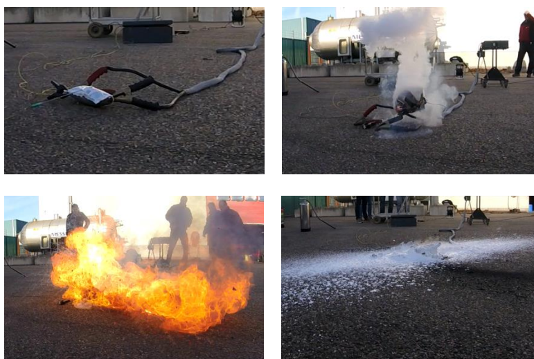
Figuur 1. Linksonder: Cel bouwt druk op. Rechtsboven: Cel ontploft om druk te verlagen, geen ontbranding. Linksonder: Na verder overladen komt cel tot ontbranding. Rechtsboven: Geblust met Berki Cold
