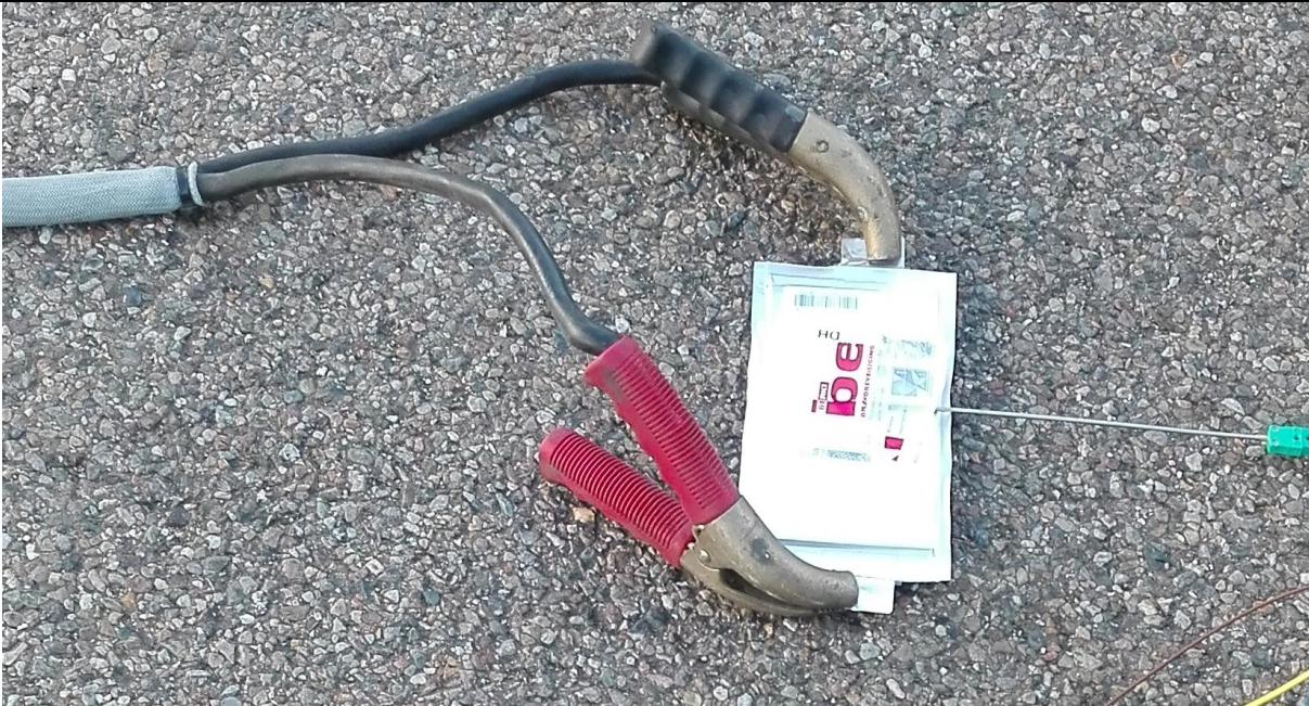
Figuur 8. Testopstelling zonder spanningssensoren
