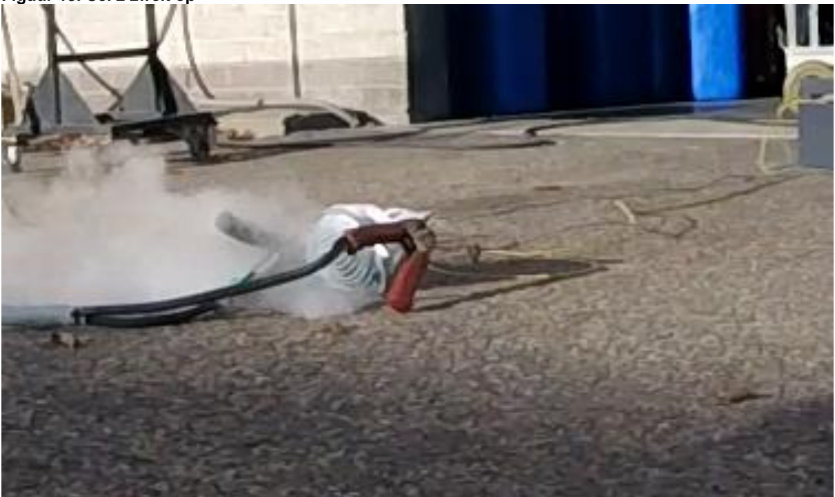
Figuur 14. Cel 2 scheurt open
