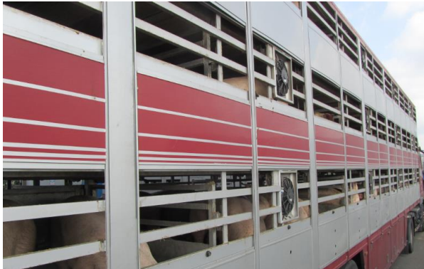
Figuur 11 Conventionele veewagen, ventilatie grotendeels afhankelijk van rijwind © Eyes on Animals
