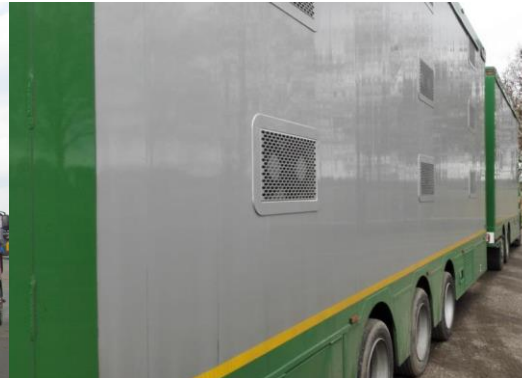
Figuur 12 Dwarsgeventileerde veewagen, de ventilatoren draaien op elektriciteit, ook als de wagen stil staat © Eyes on Animals
