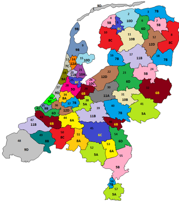
Figuur 2 Overzicht allotments voor lokale digitale radio-omroep in Nederland Nabuurkanaal interferentie kan onder andere worden veroorzaakt door de allotments voor lokale digitale radio-omroep in Nederland zoals weergegeven in figuur 2.
