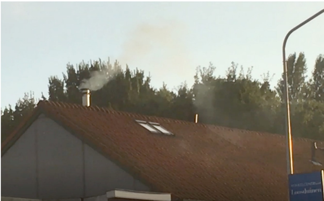
Afbeelding 8.15: Lijwerveffect waardoor de rookpluim omlaag wordt gezogen.
