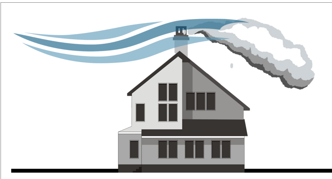
Afbeelding 8.13: Downwash effect bij rookgasafvoer boven nokhoogte
