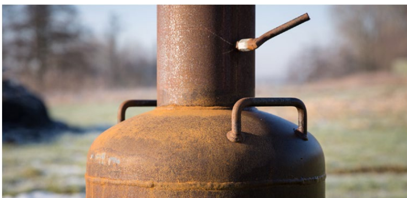
Afbeelding 4.1: Smoorklep in een terraskachel
