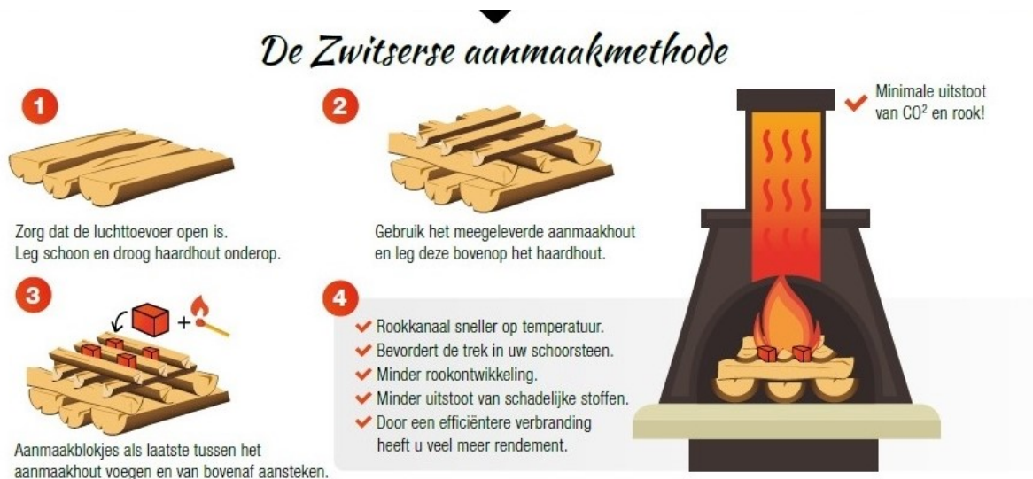
Afbeelding 4.3: Uitleg van de zogenoemde Zwitserse aanmaakmethode
