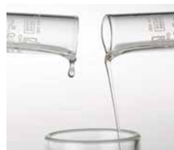
VISCOSITEIT SHELL GTL FUEL (LINKS)
