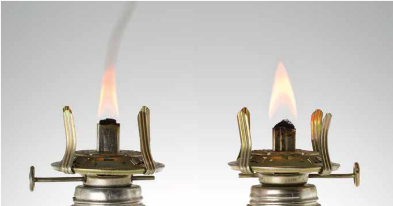
VISUALISATIE VAN ROETVOORDELEN CONVENTIONELE DIESEL (LINKS) EN SHELL GTL FUEL (RECHTS)
