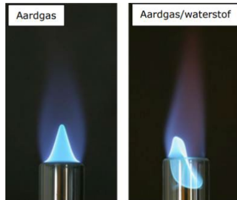
Figuur 5 Voorbeeld vlaminslag als gevolg van waterstofbijmenging aan aardgas (DNV GL, 2020a).
