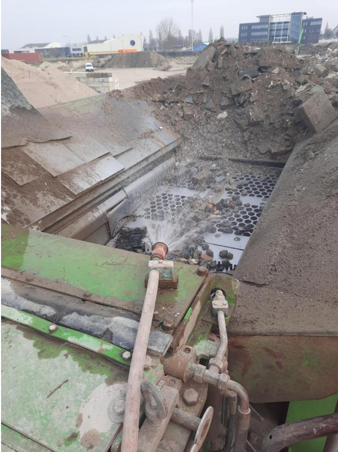
Afbeelding 5.1 Sproeien bij de inlaat van de puinbreker
