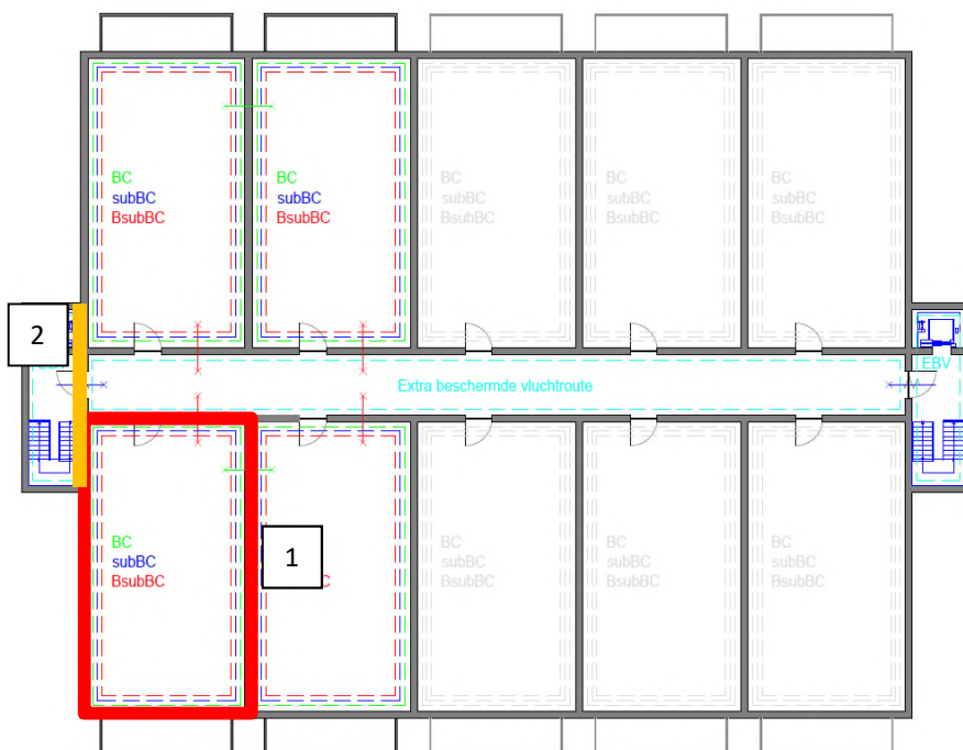
Figuur B3.2-1 Verdedigingslijnes in woongebouw met corridor
