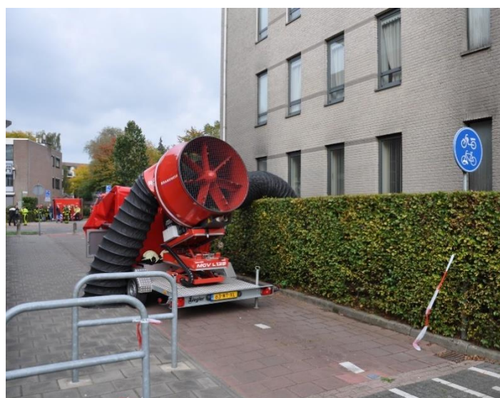
Foto 11: Grote ventilator zuigend ingezet in nooduitgang parkeerkelder.
