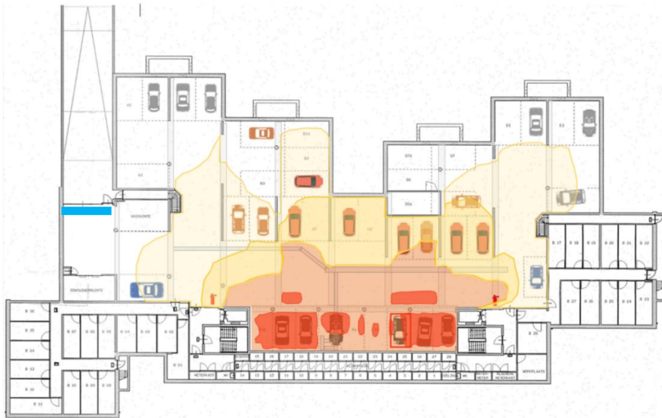
Figuur 7: Schadebeeld constructie, plafond en personenauto's in de parkeerkelder.
