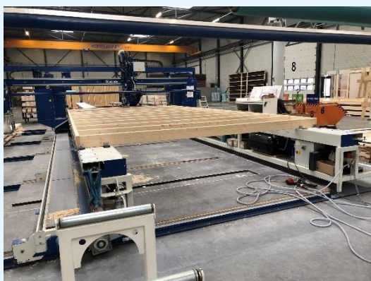
figuur 4: samenstelling frame HSB-gevelelement
