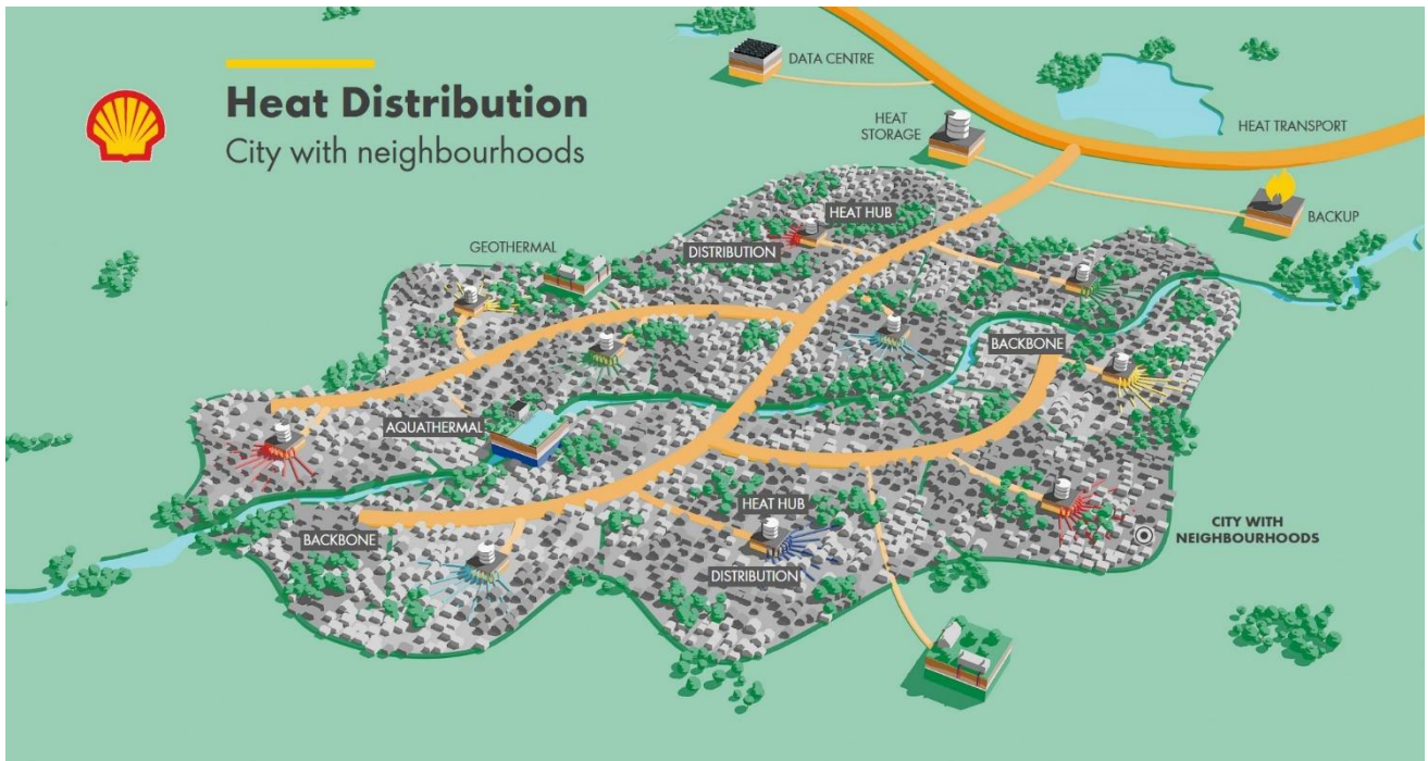
Voorbeeld van een warmtebackbone op gemeentelijk niveau, waarop verschillende bronnen (aquathermie, aardwarmte en een datacentrum) zijn aangesloten, evenals warmteopslag en een backbonevoorziening. Shell pleit voor open backbones (bijvoorbeeld één voor een grootstedelijk gebied) die meerdere warmtekavels ontsluiten, waarop verschillende bronnen en opslagvoorzieningen kunnen worden aangesloten en waarop meerdere warmteleveranciers actief kunnen zijn.
