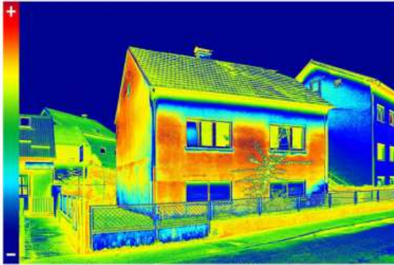
Met een warmtebeeld van een woning kunnen energielekken worden opgespoord. Gettyimages
