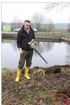
Foto's 04 en 05: Toepassen elektrische methode onkruidbestrijding. Foto links de elektrische lans, Foto rechts de aarding.
