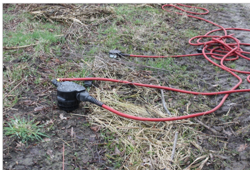
Foto's 04 en 05: Toepassen elektrische methode onkruidbestrijding. Foto links de elektrische lans, Foto rechts de aarding.
